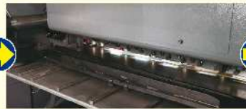
BG(バックゲージ)が後退し、サポートが上がります
